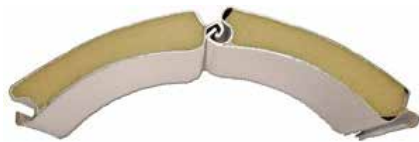
Lame alu avec isolation mousse polyuréthane - 77mm de hauteur visible - Lame finale avec joint d'étanchéité au sol
